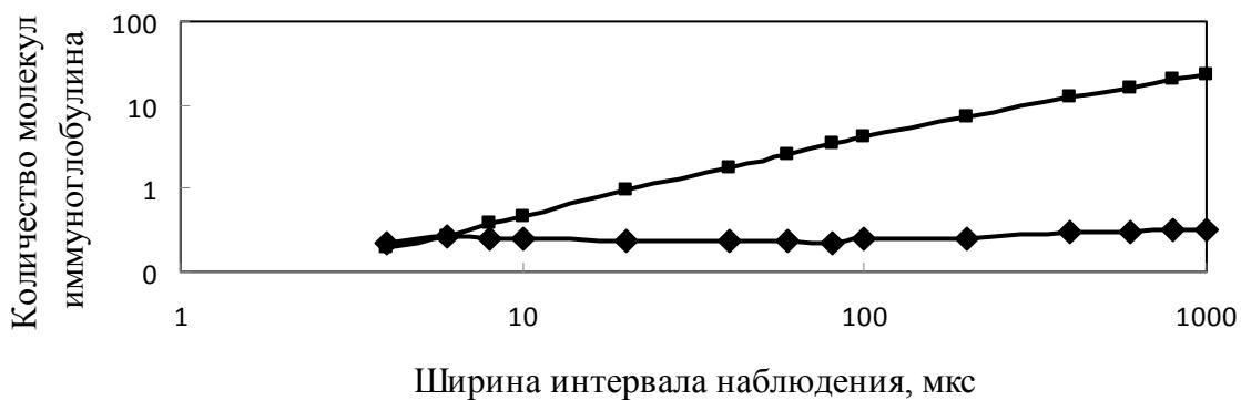
Рис. 4. График зависимости количества молекул иммуноглобулина в исследуемом объёме от ширины интервала наблюдения без коррекции ■ и с коррекцией ♦
