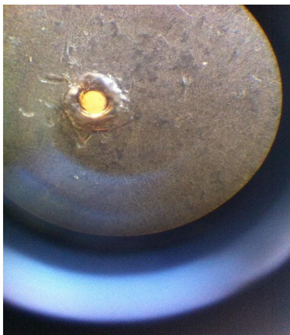
Рис. 2. Изображение отверстия диаметром 100 мкм через микроскоп МИР - 12
