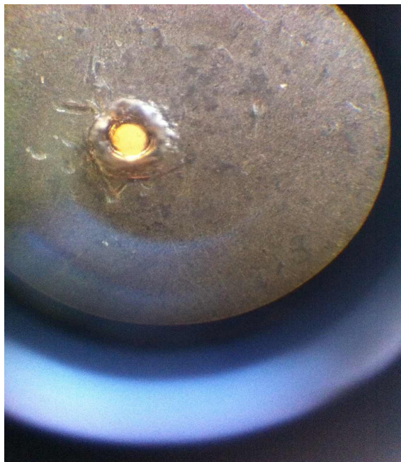
Рис. 2. Изображение отверстия диаметром 100 мкм через микроскоп МИР - 12
