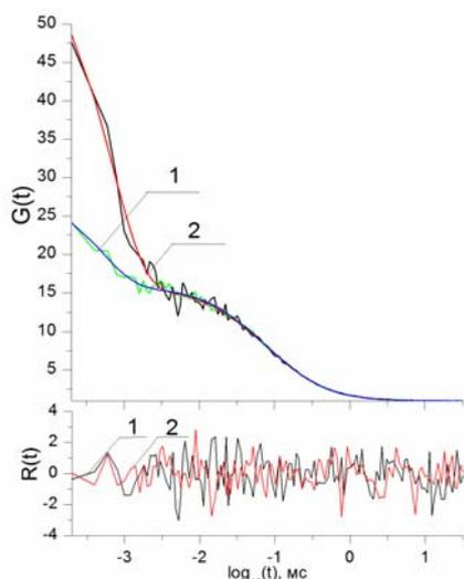
Рис. 1. Вид АКФ  $G(t)$  и нормированных остатков  $R(t)$  при обоих излучательных состояниях молекулы (1) и одном излучательном состоянии (2).
