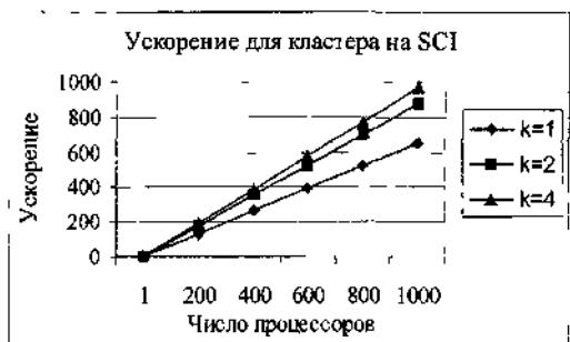
Рис.3. Ускорение для большого кластера с сетью SCI
