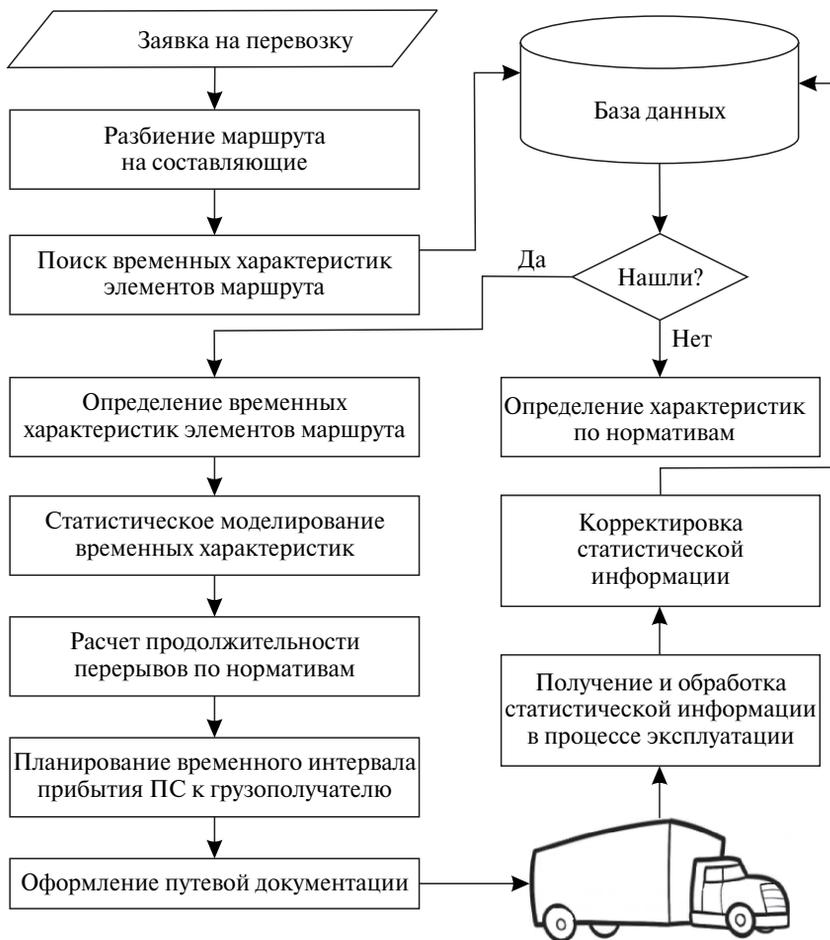
Рис. 5.12. Обобщенный алгоритм определения времени доставки груза в рамках транспортного процесса
