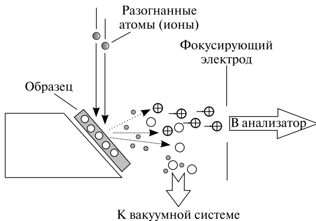
Рис. 25. Схема устройства источника ионизации быстрыми атомами
