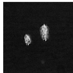
Рис. 1. Увеличенная фотография микродефекта в стекле
