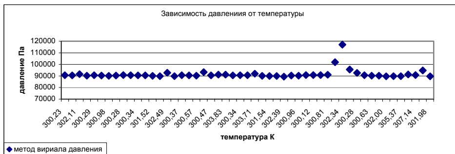
Рис. 3. Зависимость давления от температуры (метод вириала)
