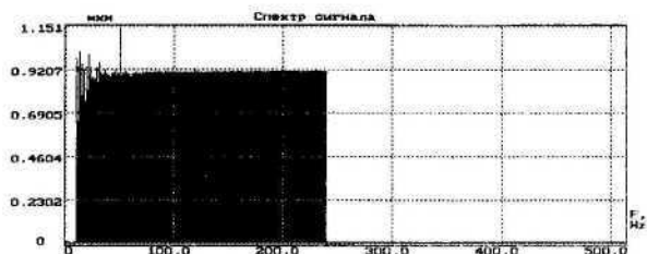
Рис. 4 – Спектр вибросигнала в точке задания в единицах виброперемещения, частотный диапазон 10-240 Гц
