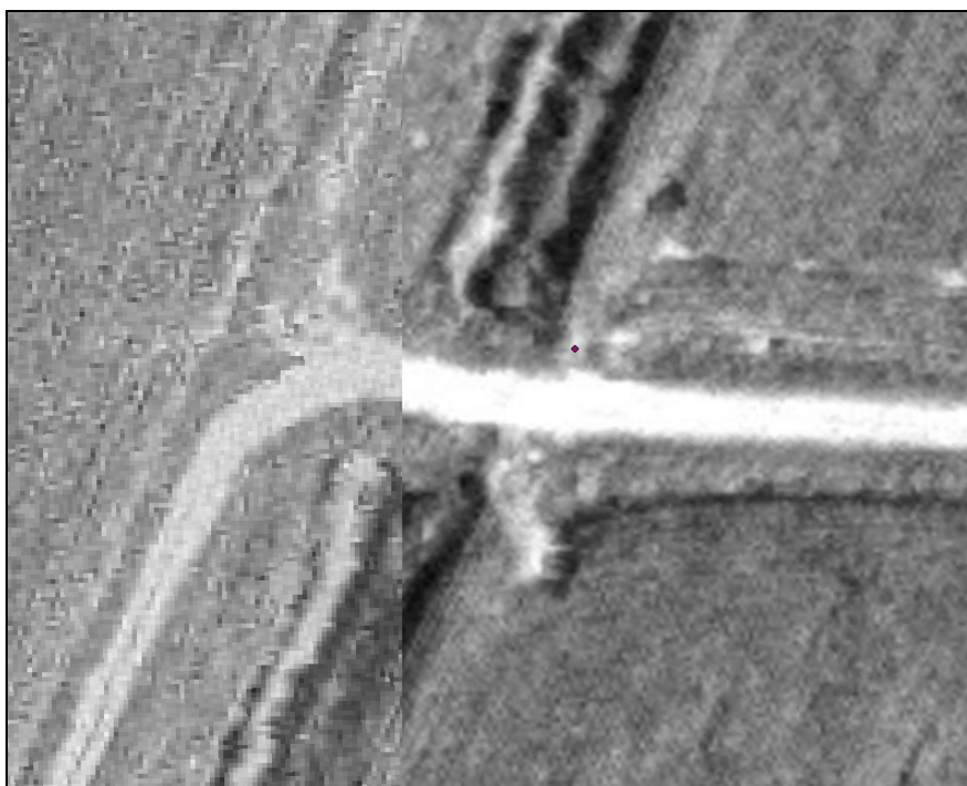
Рис. 2. Смещение дороги как пример смещения точек на ортофотоплане и ортомозаике
