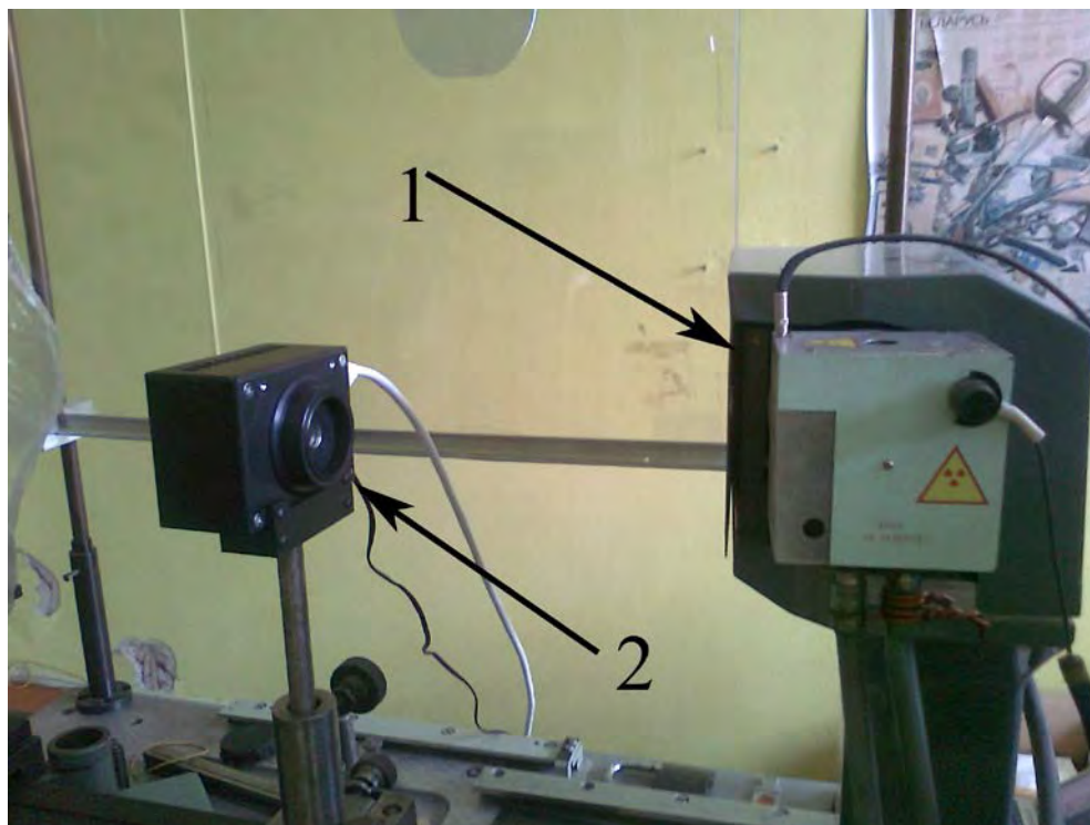
1- рентгеновская трубка в кожухе; 2- регистрирующая камера
