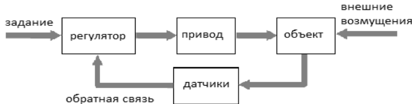
Рис. 2. Блок-схема системы автоматического управления
