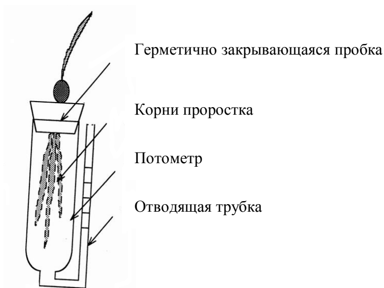
Рис. 4. Схема установки для измерения скорости поглощения воды растением (потометр).
