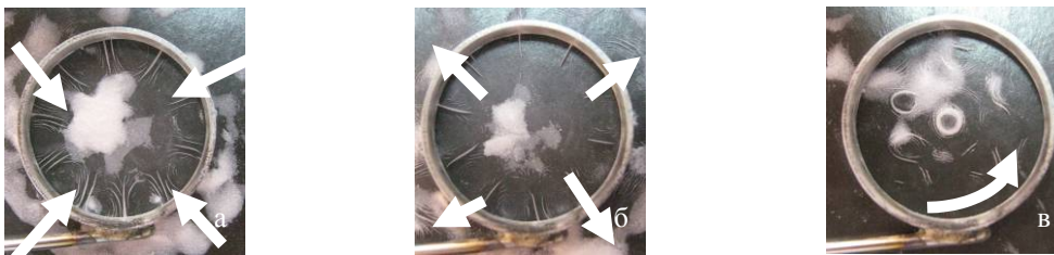
Рис. 2. Упорядоченные структуры порошка в акустическом поле кольца
