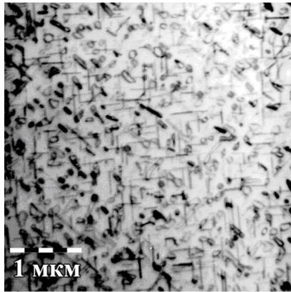
Рис. 1. ПЭМ фотография кремния, легированного бором в один шаг дозой  $1,5 \cdot 10^{15} \text{ см}^{-2}$ . Отжиг БТО в течении 10 секунд при  $1000 \text{ }^\circ\text{C}$  в  $\text{N}_2$  (SiB-1)
