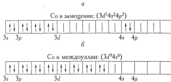
Рис. 3. Расположения электронов на орбиталях: а – в узле решетки кремния атома кобальта, б – в междоузлии решетки кремния атома кобальта
