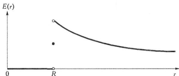
Рис. 3. Зависимость напряженности электрического поля  $E(r)$  от расстояния  $r$  до исследуемой точки
