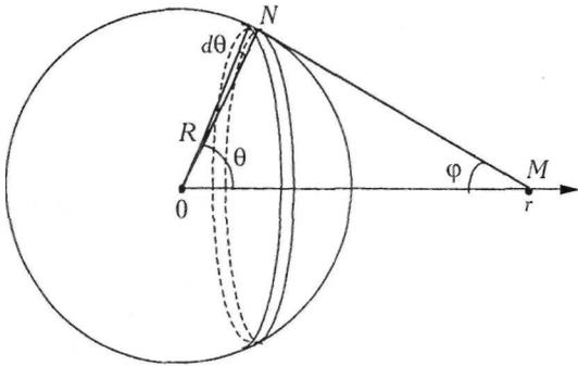
Рис. 1. Вычисление напряженности электрического поля равномерно заряженной сферы
