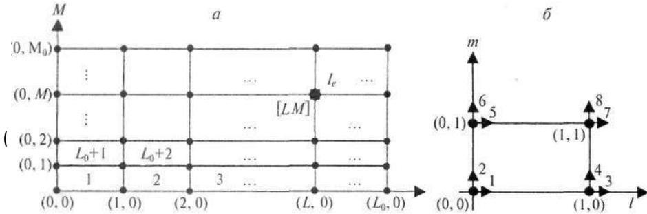
Рис. 1. Регулярная прямоугольная сетка, состоящая из прямоугольных элементов – а; элемент с четырьмя узлами – б
