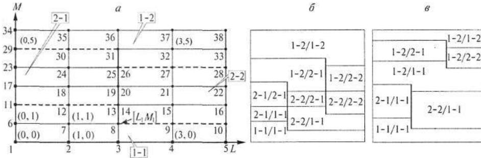
Рис. 2. Сетка из одинаковых четырехузловых элементов, содержащая вертикальную трещину – а; тело с двумя вертикальными трещинами, перекрывающимися друг друга в горизонтальном направлении – б; тело с двумя вертикальными трещинами, лежащими в разных слоях – в
