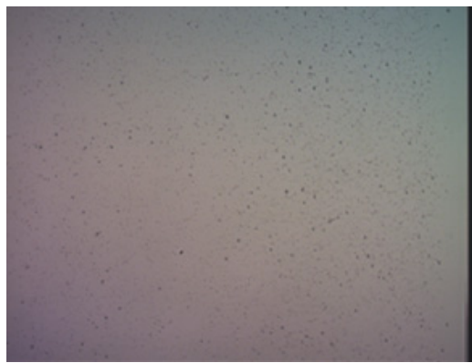
Рис. 1. Микрофотография поперечного скола пластины, после БТО 1150 °C (10×30 с) + 700 °C (24 ч)
