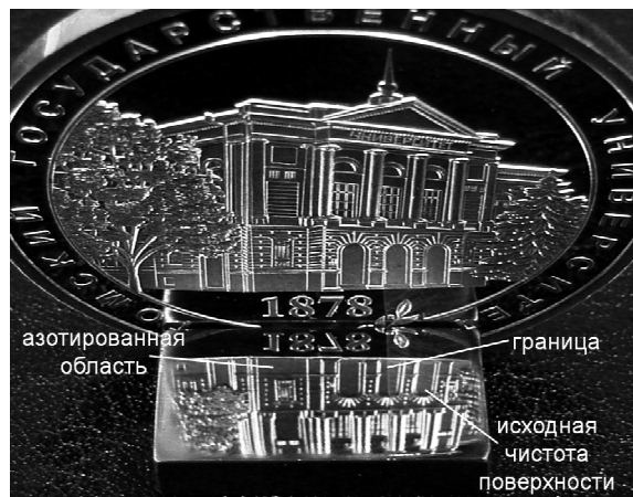
Рис. 3. Фотография азотированного стального образца
