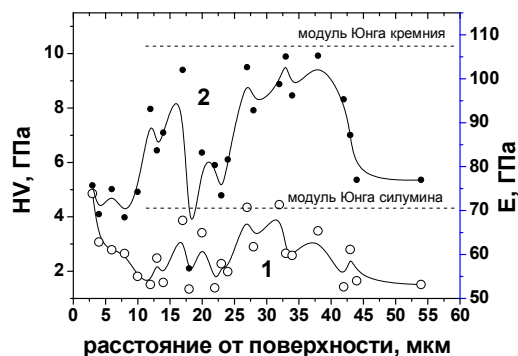
Рис. 4. Зависимости величины микротвердости (1) и модуля Юнга (2) от расстояния до поверхности слоя облучения силумина электронным пучком
