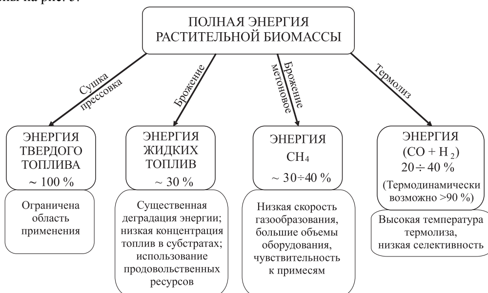
Рис. 5. Сопоставление энергетического выхода для различных способов переработки растительной биомассы в топливо
