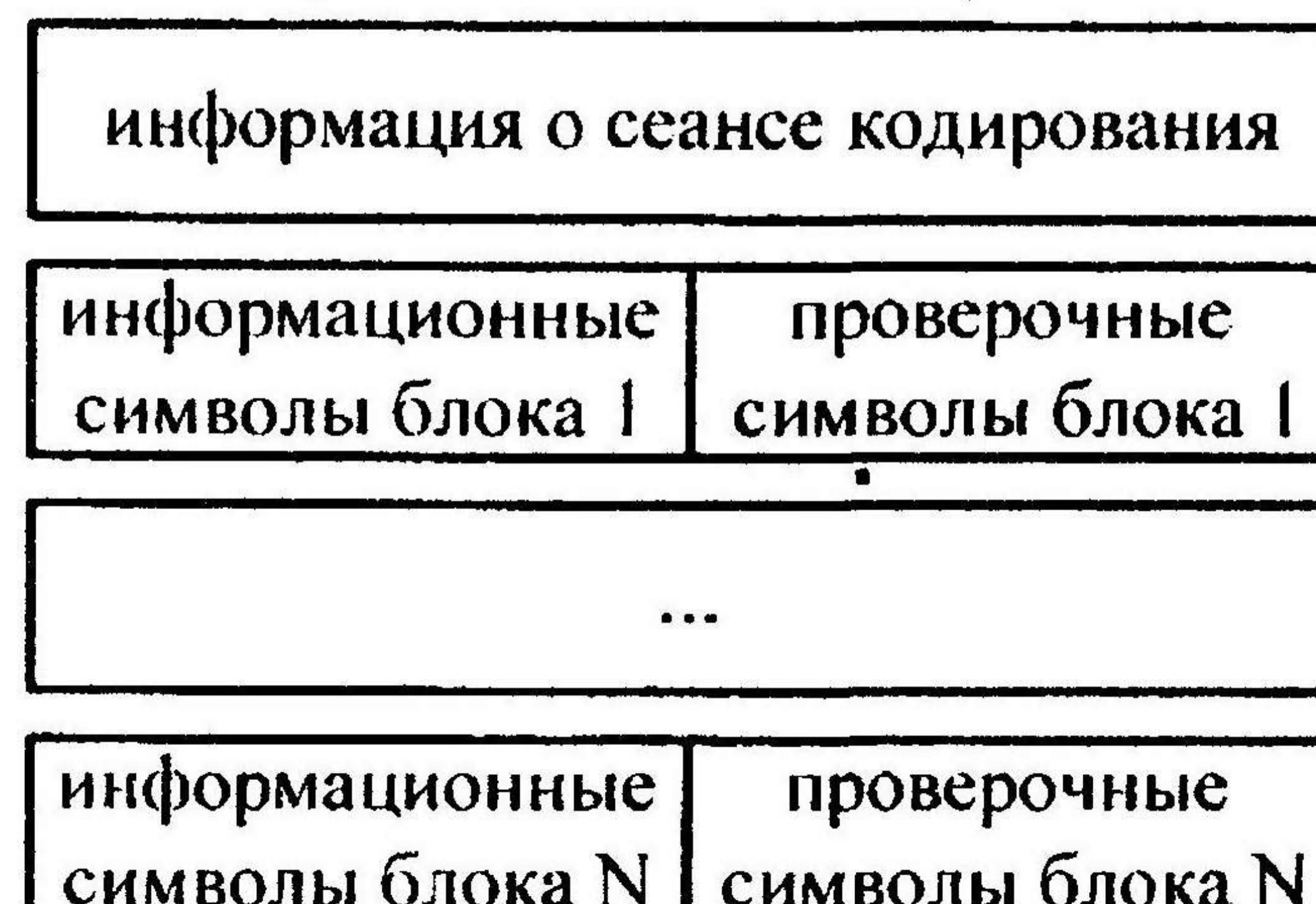
**Рисунок 3 – Представление информации при адаптивном раздельном кодировании**
