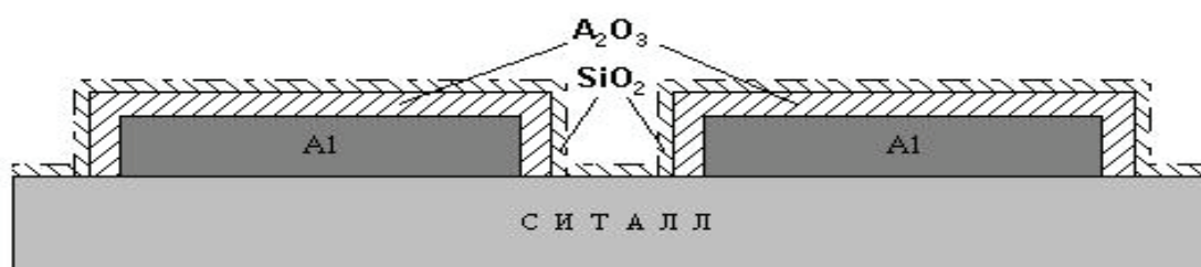
Рисунок 1 – Обобщенный поперечный разрез емкостного датчика
