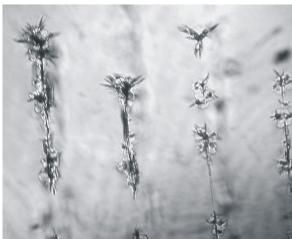
Рис. 1. Микрофотография типичного разрушения в объеме оптического стекла в экспериментах вне резонатора (вторая гармоника \text{Nd}^{3+} :YAG лазера, стекло К8)
