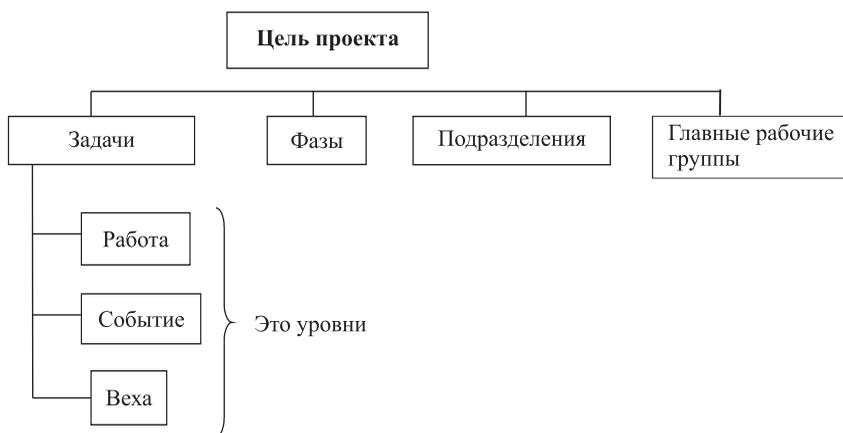
Рис. 6.1. Структура разбиения работ (СРР)
