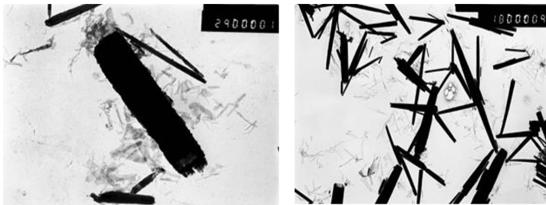
Рисунок 6 – Фотография НЧ ZnO (длина 1,0 мкм, диаметр 85,0 нм)
