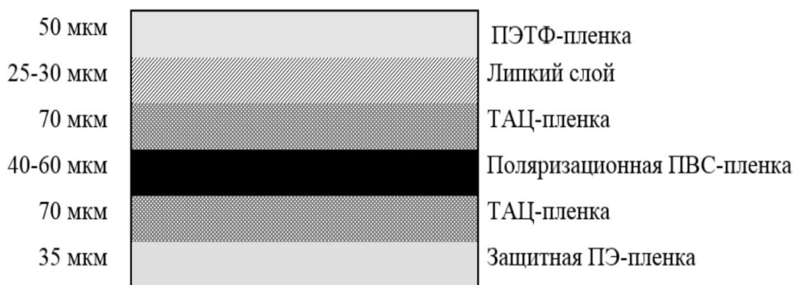
Рисунок 1 – Принципиальная схема поляризатора
