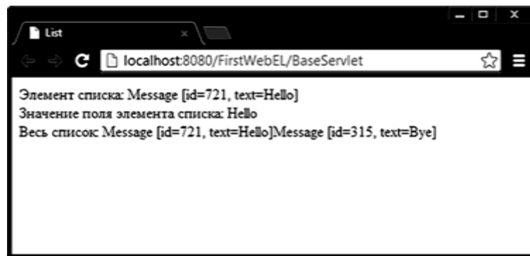
Рисунок 10 - Использование EL для доступа к элементам списка
