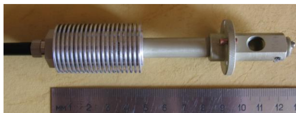
Рисунок 5 – Экспериментальный образец лазерно-плазменного двигателя на основе импульсного мини лазера RL1.0Q (без блока питания и системы подачи рабочего тела)
