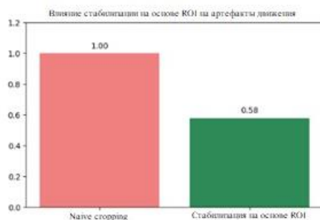
Рис. 3. Сравнение артефактов движения при наивном кадрировании и стабилизации на основе области интереса (измерено с помощью нормализованной среднеквадратической ошибки)
