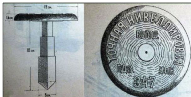
Рис. 1. Устройство нивелирного знака ВГУ [3]
