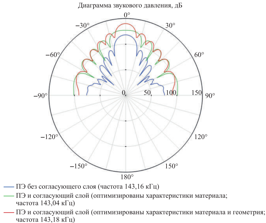
Рис. 5. Изменение диаграммы звукового давления
