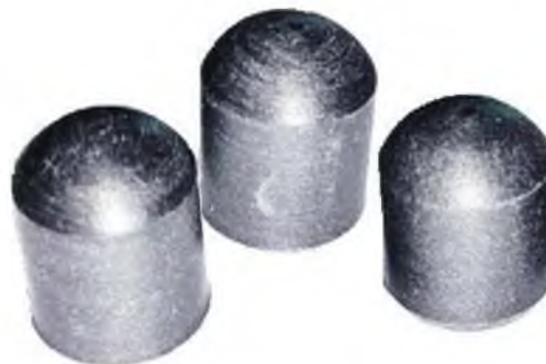
Рис. 1. Образцы из фторопласта «Суперфлувис» до испытаний на интенсивность износа
