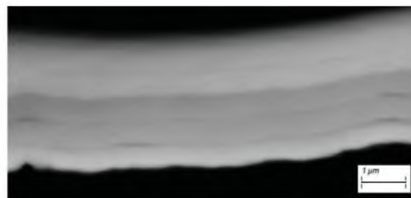
Рис. 1. Морфология поперечного сечения образца с покрытием (\text{Zr,Hf})\text{N}/(\text{Zr,Nb})\text{N}
