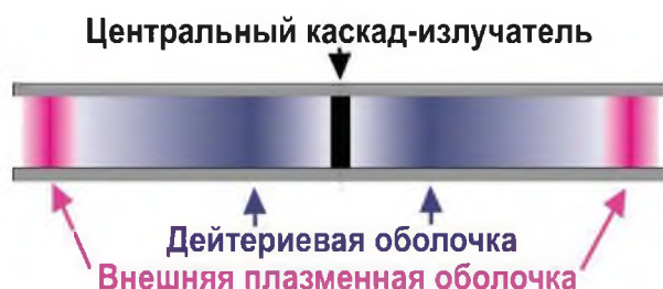
Рис. 1. Схематичное изображение гибридного лайнера с внешней плазменной оболочкой
