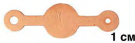
Рис. 2. Изображение электровзрываемого проводника, полученного из прессования медного порошка
