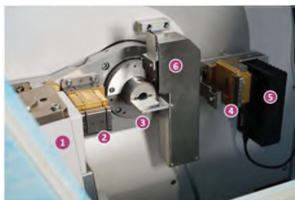
Рис. 2. Внутреннее рабочее пространство дифрактометра PowDiX 600. 1-рентгеновская трубка, 2, 4-оптические элементы, 3-образец, 5-детектор, 6-коллиматор-нож (опционально)
