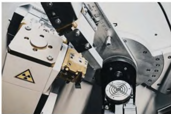
Рис. 7. Пример съемки с несимметричным расположением плеч
