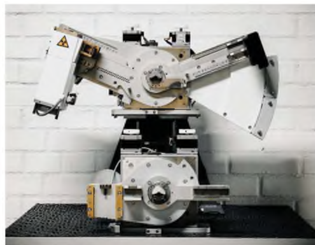
Рис. 11. Гониометр для перспективной системы с радиусом 300 мм. Для сравнения внизу показан гониометр базовой системы
