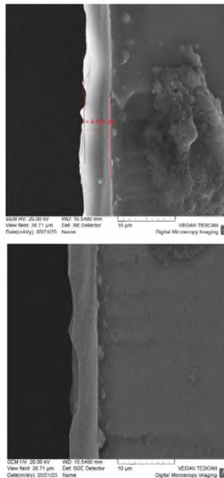
Рис. 1. Поперечный скол кремниевой пластины с полимеризованным покрытием (внизу – фазовый контраст)
