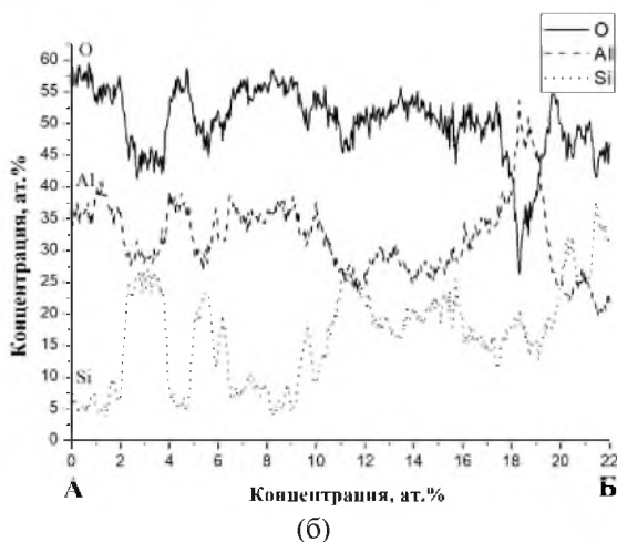
Рис. 1. Морфология поверхности исходного силумина, подвергнутого анодированию (а) и распределение элементов (б) вдоль линии АБ на рис. 1а
