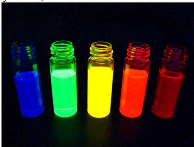
Рисунок 35 – Зависимость цвета фотолюминесценции от размера квантовых точек CdSe (изменение размера слева направо – от 1,5 до 6 нм)
