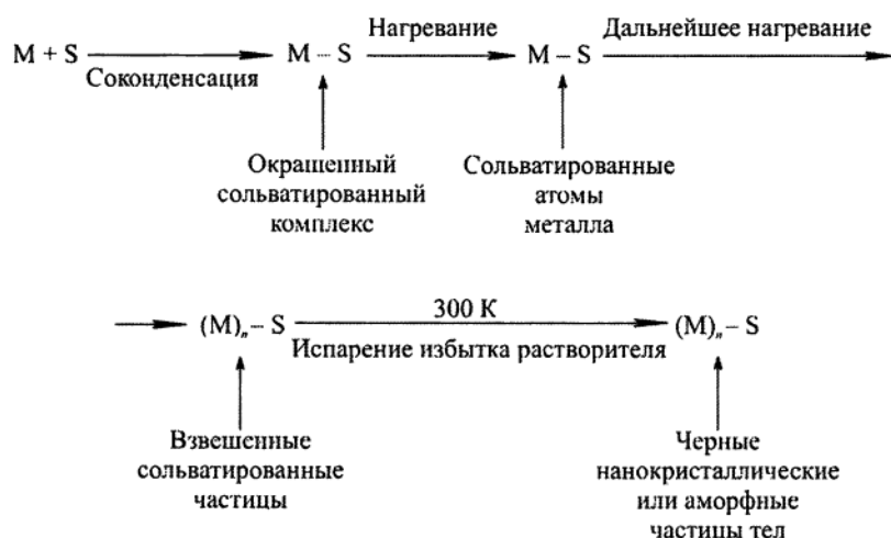
Рисунок 34 – Схема получения дисперсий сольватированных атомов металла методом криоконденсации (M – металл, S – растворитель)
