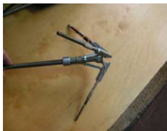
Рис.1. Сенсор магнитного поля для космических аппаратов
