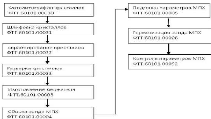
Рис. 4. Технологический процесс изготовления МПХ
