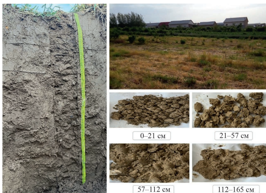
Рис. 4. Морфологические признаки разреза 3 в северо-восточном направлении Каттакурганского водохранилища
