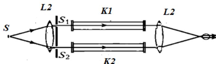
Рис.1. Принципиальная схема интерферометра Рэлея (вид сверху)
