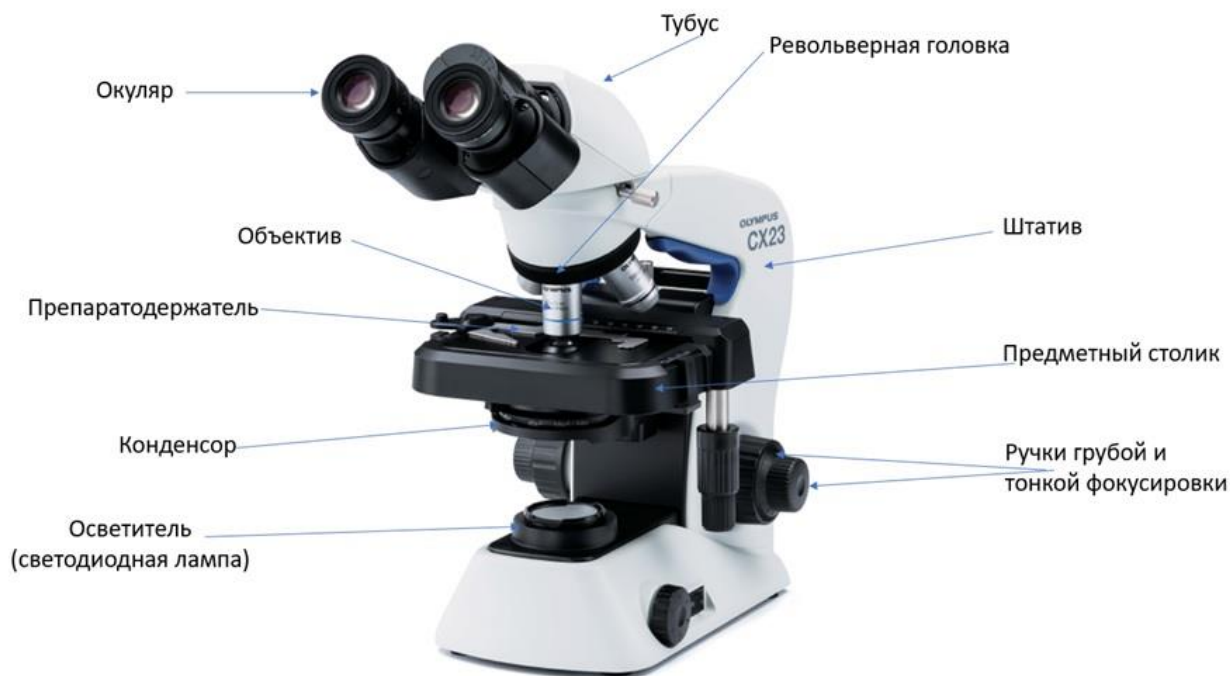
Рисунок 20 – Устройство светового микроскопа.
