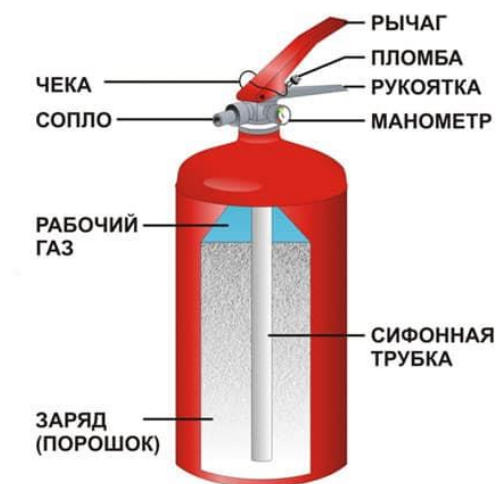
Рисунок 1 – Устройство порошкового огнетушителя
