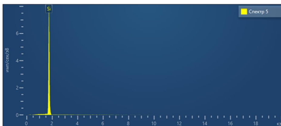
Рисунок 8. – Рентгеновский спектр пленки AZ nLOF 2070 толщиной 5,9 мкм после выдержки в парах спирта, снятый на светлом поле (рисунок 5)
