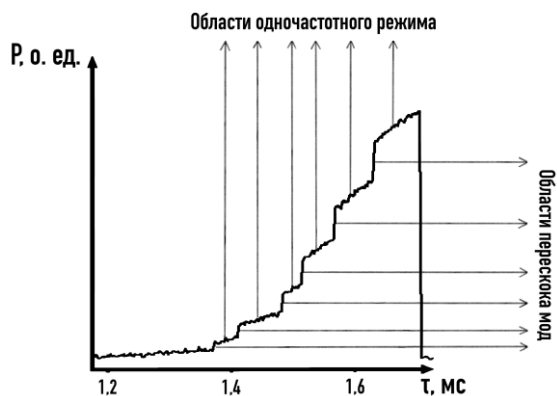
Рис. 4. Сигнал на выходе фотоприёмника в интерферометре с разностью длин плеч 50 мкм
