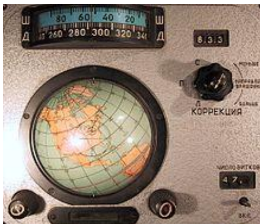
Рисунок 26 – Навигационная система «Глобус» на панели управления космического корабля «Восход»
