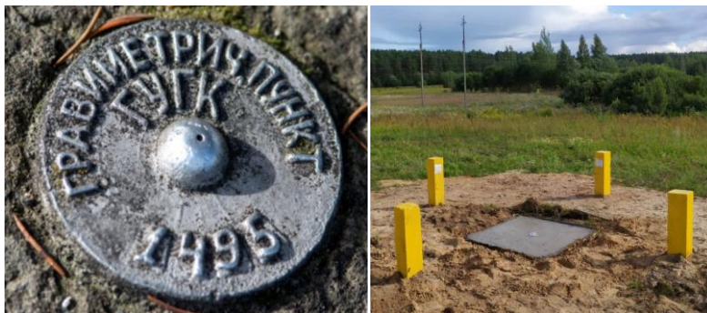
Рисунок 9 – Обозначение на местности пунктов ГГрС: центр (слева) и наружное оформление гравиметрического пункта (справа)
