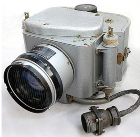
Рисунок 44 – Аэрофотоаппарат (АФА) и схема его устройства
