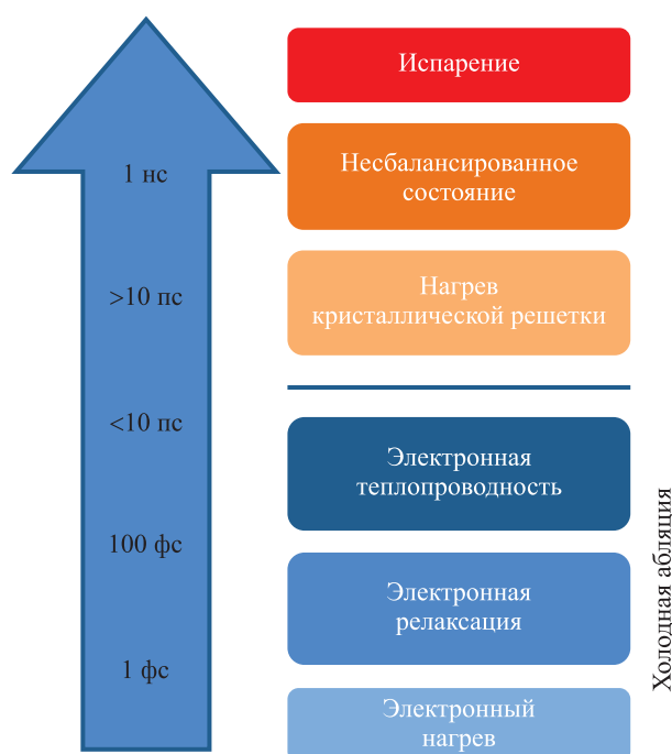
Рис. 3. Временные рамки объемного поглощения энергии лазерного импульса материалом
